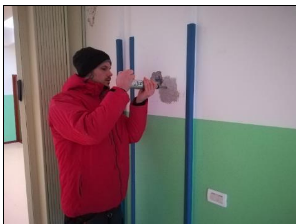
Esecuzione dell'indagine sclerometrica.
