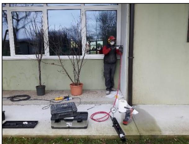
Esecuzione delle indagini di pull out.
