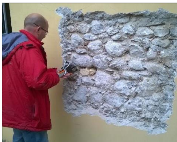
Due fasi dell'indagine con penetrometro da malta.
