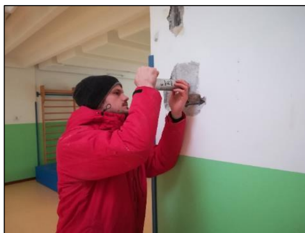
Esecuzione dell'indagine sclerometrica.
