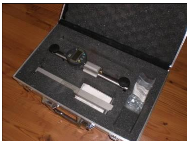
Deformometro, barra di taratura e moto troncatrice.
