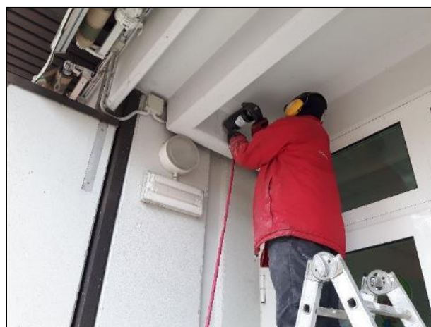
Esecuzione delle indagini di pull out.
