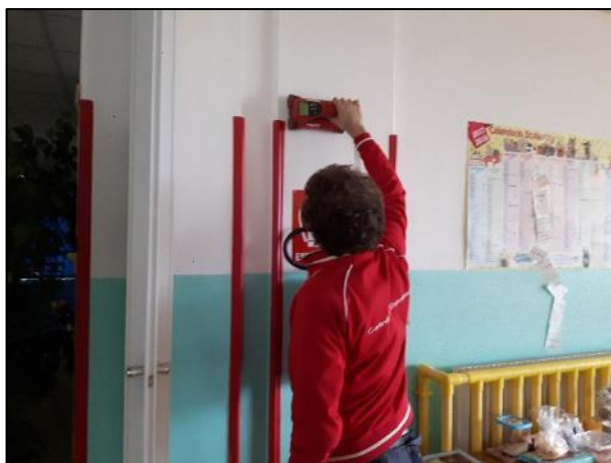
Una fase dei rilievi pacometrici e delle microdemolizioni
