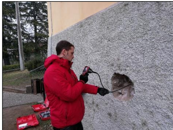
Due fasi dell'indagine videoendoscopica sulle murature.
