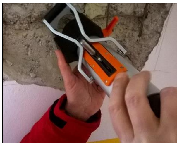
Due fasi dell'indagine con penetrometro da malta.
